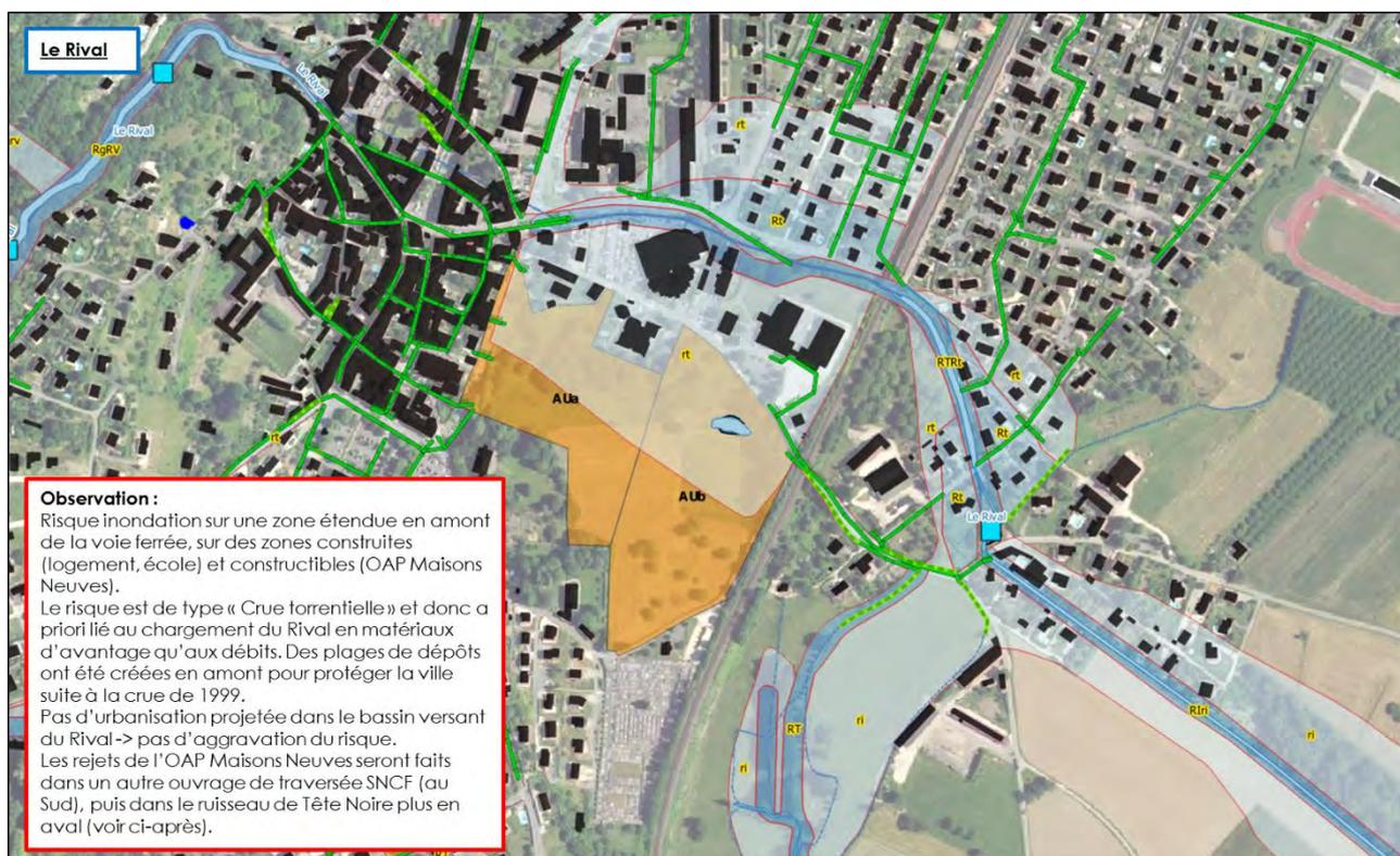
Le Rival est soumis au risque de crue torrentielle. La création de deux plages de dépôts en amont du bourg permet de limiter le risque d'embâcles au niveau des couvertures sous les zones urbaines.
